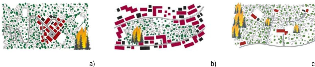
Figura 21. Tipologie di incendi di interfaccia: classica (a), occlusa (b) e mista (c)
